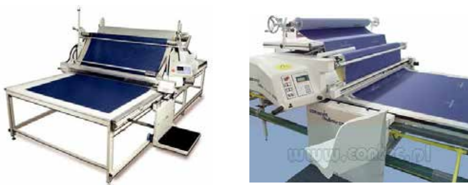
Rys. 6. Automatyczne lagowarki: po lewej Gerber Spreader model Xls 125 (firma GT) 21 , po prawej Compact E100-400 (firma Bullmer) 22 .
