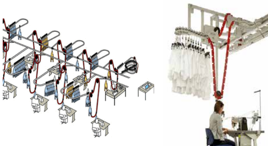
Rys. 8. Automatyczny system transportu międzyoperacyjnego – Eton Unit Production System (firma Eton) 28 .
