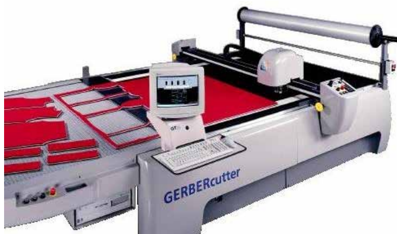
Rys. 7. Automatyczny nóż tnący GTxL (firma GT) 23 .
